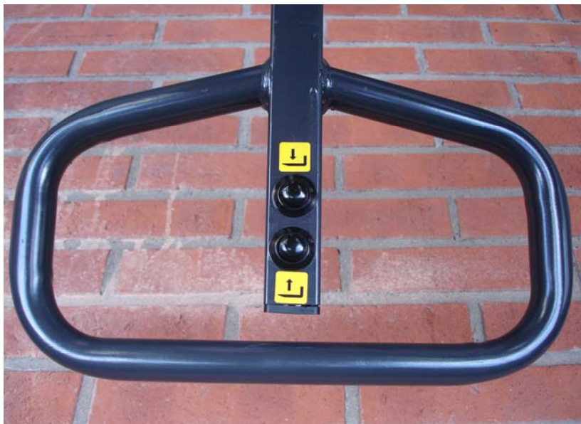
B07 Handtag med tryckknapps funktion för höjning och sänkning, för finjustering höj/sänkning finns extra reglage vid kåpan.
