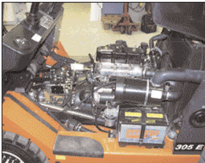
Truckchassit består av en kraftig bottenplatta med löstagbara sidor. Observera de långa tiltcyklindrarna infästa vid sidan av Perkinsmotorn.
