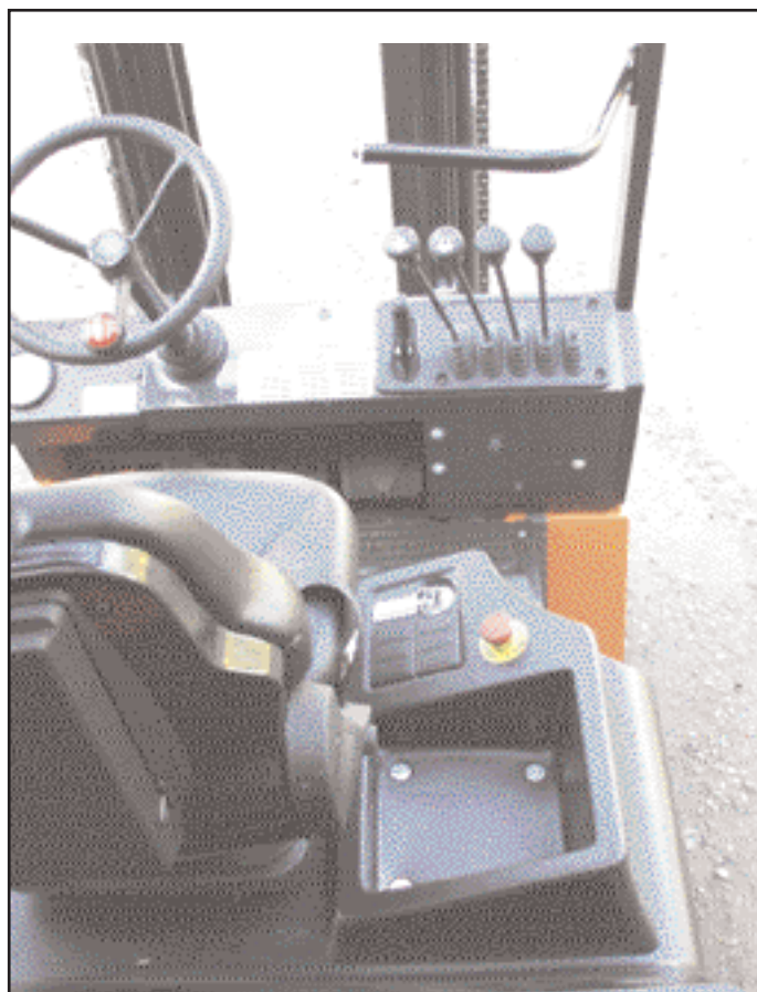
Högst konventionellt utformad förarplats med manöverspakarna för gafflarna placerade i "torpeden". Inget överbetyg för ergonomin – men fullt tillräcklig komfort för en truck av detta slag.
